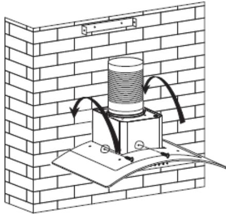
7. Поставьте декоративный короб на вытяжку и затяните, используя 2 шурупа (4мм x 8мм).
