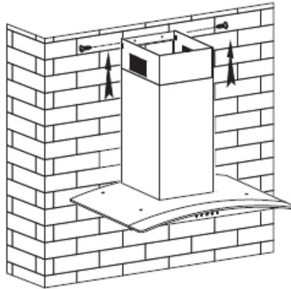
8. Убедитесь, что вытяжка установлена ровно относительно поверхности. Любое отклонение может повлечь за собой раннюю поломку устройства.
