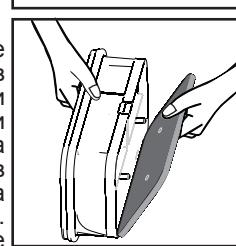
5. Установите переднюю крышку (в направлении стрелки) и протолкните ее на место, убедившись в том, что она встала на место. Задейтесь, повернув их по часовой стрелке.
