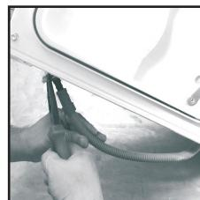
3. Вытяните шланг из мостового соединения.
