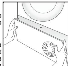
2. Поверните два фиксирующих рычага против часовой стрелки и потяните переднюю крышку.
