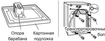
Снимите транспортировочные болты и опоры.
