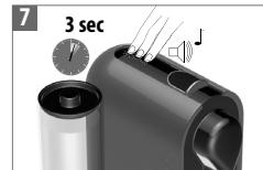
Pulse los tres botones simultáneamente durante más de 3 s. Sonará una señal acústica de confirmación. El área de los controles comenzará a parpadear rápidamente.
