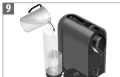
Fyld den brugte afkalkningsopløsning, som er opsamlet i beholderen, tilbage i vandbeholderen, og tryk på en knap for at gentage proceduren.
