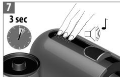
Appuyez sur les 3 boutons en même temps pendant au moins 3 secondes. Un court signal sonore confirmera l'enclenchement. Les boutons de commande se mettront à clignoter rapidement.
