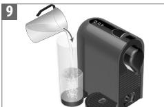
Remplissez le réservoir d'eau avec la solution de détartrage usagée recueillie dans le récipient et touchez n'importe quel bouton pour répéter la procédure.
