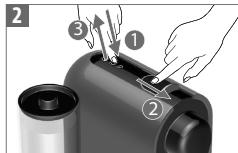
Trykk på knappen og hold den inne mens du lukker skyvestykket. Slipp når du har oppnådd ønsket mengde. De to andre knappene blinker. Vannmengden er nå lagret for den knappen som ble brukt under programmeringen. Tryck och håll kvar touchknappen medan luckan stängs. Släpp knappen när önskad vattenvolym har uppmätts. De andra två touchknapparna blinkar. Vattenvolymen för den touchknapp som användes vid programmeringen är nu sparad.
