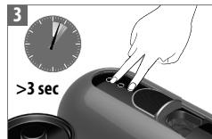
Slik endrer du automatisk deaktivering (AV-modus) fra ni til 30 minutter: hold skyvestykket lukket, trykk og hold både Lungo- og Ristretto-knappene inne i mer enn tre sekunder. Espresso-knappen blinker én gång. För å gå tillbake til ni minutter er det bare å gjenta denne prosedyren. Espresso-knappen blinker tre ganger.
