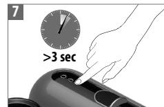
La machine peut être mise en mode Arrêt à tout moment quand la fenêtre coulissante est fermée en maintenant appuyé un des boutons tactiles pendant plus de 3 sec, confirmé par les 2 autres boutons clignotants.
