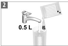
Fyld vandbeholderen med 1 portion Nespresso afkalkningsvæske, og tilslæt 0.5 L vand.
