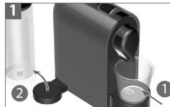
Merk at maskinen er blokkert i ti minutter etter tömming! Fjern vanntanken. Plasser en beholder under kaffeutløpet.
