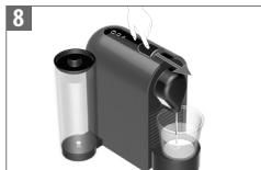
Kireç çözme işlemini başlatmak için kaydırıcıyı kapatın. Su tankı boşaldığında makine kapanır. Чтобы начать удаление накипи, закройте слайдер. Кофемашина остановится при опустошении резервуара для воды.
