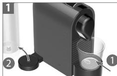
Importante: la máquina permanecerá bloqueada durante 10 minutos después del vaciado. Retire el depósito de agua. Coloque un recipiente debajo de la salida del café. De salientar, a máquina fica bloqueada durante 10 minutos após o esvaziamento! Retire o depósito de água. Coloque um recipiente debaixo da saída de café.
