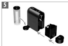
Βάλτε το δοχείο νερού στο βραχίονα του, η θέση του σταθεροποιείται με μαγνήτες. Τοποθετήστε το δίσκο αποστράγγισης και το δοχείο συλλογής καψουλών στη θέση τους. Για την ασφάλειά σας, χρησιμοποιήστε τη μηχανή μόνον όταν ο δίσκος αποστράγγισης και το δοχείο συλλογής καψουλών βρίσκονται στη θέση τους.
