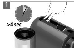
Appuyez et maintenez enfoncé les boutons Espresso & Lungo pendant au moins 4 secondes. L'autre bouton clignote pour confirmation. Press and hold the Espresso & Lungo controls together for at least 4 sec. The other control flashes for confirmation.
