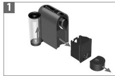
Su tankını ve kapsül kabini çıkarın. Kablo uzunluğunu ayarlayın ve kablo kılavuzundaki fazlalıkları makinin altında muhafaza edin. Снимите резервуар для воды и контейнер для капсул. Отрегулируйте длину сетевого шнуря в отсеке для хранения шнуря под кофемашиной.
