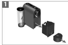
Fjern vanntanken og kapselbeholderen. Juster kabellengden og oppbevar overskytende kabel under maskinen.
