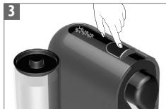
Mettez la machine en marche en poussant la fenêtre coulissante ou en touchant les boutons. Lumière clignotante sur l'une des touches de café: chauffage pendant environ 25 secondes. Voyant allumé en continu: prêt.
