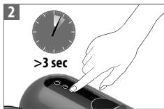
La máquina puede pasar al modo de apagado en cualquier momento cuando el deslizador está cerrado si se pulsa cualquiera de los botones durante más de 3 s. Esta acción quedará confirmada con el destello de los otros dos botones. A máquina pode ser colocada em modo OFF a qualquer momento quando o deslizante está fechado, pressionando qualquer tecla por mais de 3 segundos, confirmado pelas outras 2 teclas que piscam.
