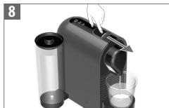
Cierre el deslizador para comenzar la descalcificación. La máquina se detendrá cuando el depósito de agua esté vacío.
