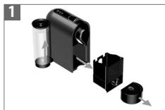
Αφαιρέστε το δοχείο νερού και το δοχείο καψουλών. Ρυθμίστε το μήκος του καλωδίου, χρησιμοποιώντας τον χρόνο αποθήκευσης του καλωδίου που βρίσκεται κάτω από τη μηχανή.
