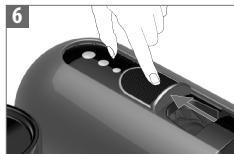
Sett PÅ maskinen ved å åpne skyvestykket og dytte det mot maskinens bakside. Blinklys på en av kaffeknappene: varmer opp i omrent 25 sekunder. Stabilt lys: klar.
