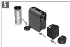
Placer vandbeholderen på armen, der holdes på plads med magneten. Sæt drypbakken og kapselbeholderen på plads. For din egen sikkerhed, skal maskinen først bruges når drypbakken og kapselbeholderen er på plads. Aseta vesisäiliö sille kuuluvalle jalustalle.
