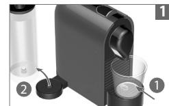
يرجى الملاحظة أن الماكينة ستتوقف عن العمل لمدة ١ دقيقة بعد عملية التفريغ. أخرج خزان الماء، ضع الماوند خت مصب القهوة.
