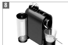
Τοποθετήστε ένα δοχείο κάτω από το στόμιο εκροής. Πλήστε το κουμπί Lungo. Κλείστε τον υποδοχέα για να ξεπλυθεί η μηχανή. Επαναλάβετε τρεις φορές.
