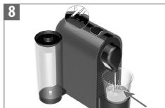
Coloque un recipiente debajo de la salida del café. Pulse el botón Lungo. Cierre el deslizador para aclarar la máquina. Repítalo tres veces.
