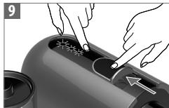
Para detener antes la salida del café, pulse el botón activo o desplace el deslizador hacia la parte trasera de la máquina hasta que se detenga. Para interrumpir o fluxo de café antes, pressione a tecla ativa ou movimento e deslizante para a parte de trás da máquina até que ela pare.
