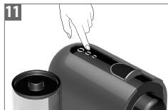
Du kan ændre den valgte kopstørrelse under brygningen ved at trykke på den nye knap for ønsket kopstørrelse. Maskinen stopper automatisk, hvis kaffemængden allerede er større end den ønskede kopstørrelse.
