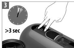
Pour instaurer le mode arrêt automatique à 9 minutes, répétez la même procédure. Pour passer le mode Arrêt automatique de 9 à 30 minutes, fermez la fenêtre coulissante et maintenez les touches Lungo et Ristretto plus de 3 secondes. Le bouton Espresso clignotera alors une fois. Pour restaurer le mode arrêt automatique à 9 minutes, répétez la même procédure. Le bouton Espresso clignotera trois fois pour confirmation.
