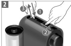
Sürgü kapağı kapatıken dokunmatik tuşu basılı tutun. İsteneilen hacime ulaşıldığında bırakın. Diğer 2 dokunmatik tuşun işiği yanacaktır. Su hacim seviyesi programlama için kullanılan tuşa kaydedilmiş olur. Нажмите и удерживайте кнопку выбранного объема, закройте слайдер. Когда кофемашина нальет нужный объем, отпустите кнопку. Две другие кнопки начнут мигать, подтверждая изменение. Уровень объема воды теперь запрограммирован для выбранной кнопки.
