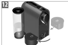
Para colocar un vaso de recetas de leche, cambie la posición del soporte para tazas al imán del lado izquierdo o derecho. La máquina expulsará la cápsula automáticamente.
