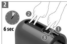
Abra el deslizador. Mantenga pulsados durante más de 6 s los botones Ristretto y Lungo simultáneamente. El otro botón se iluminará. A continuación, cierre el deslizador para iniciar el proceso.
