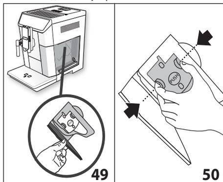
4. Нажмите вовнутрь две цветные кнопки расщепления и одновременно потяните заварочный узел наружу (рис. 50).
