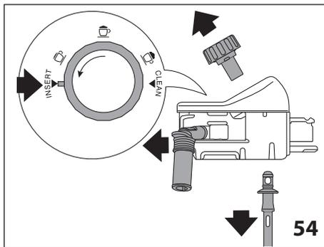
4. Тщательно промойте все компоненты водой и мягким моющим средством. **Допускается возможность очистки всех компонентов в посудомоечной машине, для чего следует разместить их в верхней корзине.** Обращать особое внимание на то, чтобы в выемке и в канале под рукояткой (рис. 55) не оставались остатки молока. При необходимости прочистить канал с помощью зубочистки.
