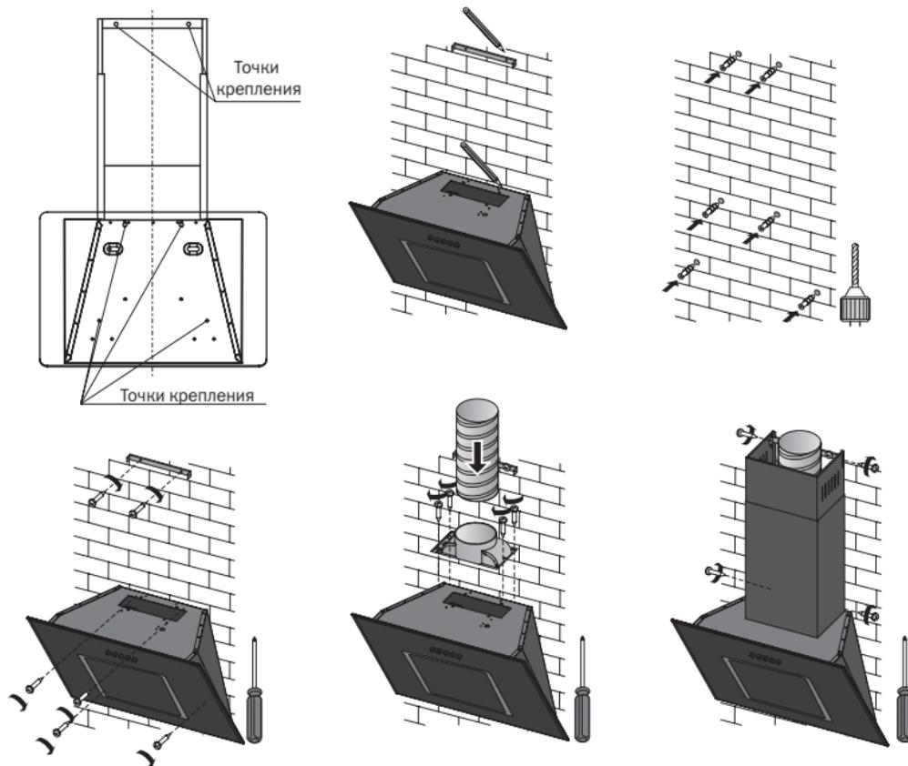
1. Прикрепите вытяжку задней поверхностью к стене при помощи саморезов с дюбелями из монтажного комплекта.
