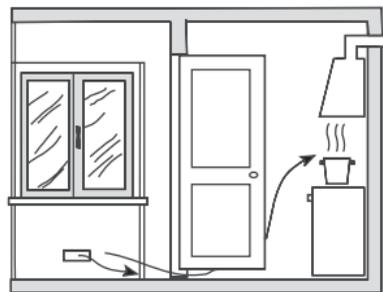
Обеспечение необходимого зазора между дверью помещения и порогом для свободного прохода приточного воздуха
