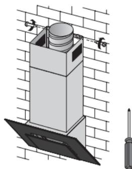
3. Установите короб воздуховода состоящий из двух частей. Нижнюю часть короба закрепите на корпусе вытяжки с помощью винтов из монтажного комплекта. Верхнюю часть короба выдвиньте на необходимую высоту и закрепите с помощью крепежной скобы и винтов из монтажного комплекта.
