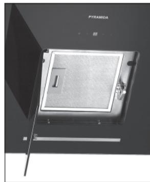
Модель HES 30 D оборудована дверью с доводчиками. Для открытия декоративной панели в вытяжках HES 30 D /AJ необходимо потянуть на себя нижний край декоративной панели, чтобы защелка вышла из зацепления. Далее доводчики сами в вертикальном направлении откроют декоративную панель. Чтобы закрыть декоративную панель проделайте данные действия в обратном порядке.
