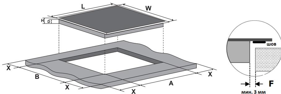
**!** Примечание: безопасное расстояние между боковыми сторонами варочной панели и внутренними поверхностями столешницы должно быть не менее 3 мм.
