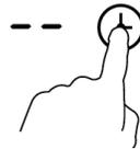
3. Установите время нажатием – или + кнопок, регулирующих таймер, индикатор начнет мигать.
