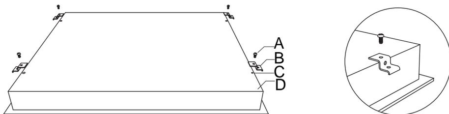
Отрегулируйте положение кронштейнов для различной толщины стола.
