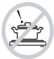
Не используйте варочную поверхность для разогрева кастрюль и сковород без продуктов питания внутри. В противном случае, ее эксплуатационные свойства могут быть нарушены и это приведет к возникновению опасности.
