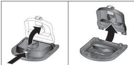
2. Для сборки вставьте нижнюю часть в обе направляющие и прижмите вниз до фиксации защелки.
