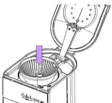
Установите держатель фильтра в прибор таким образом, чтобы ручка находилась в положении «open» (открыто).
