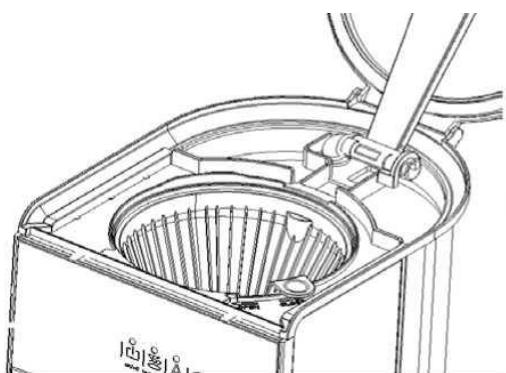
Держатель для фильтра фиксируется.
