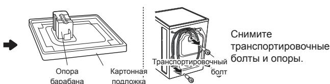
Снимите транспортировочные болты и опоры.
