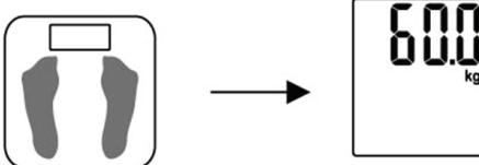
Аккуратно встаньте на весы и стойте неподвижно, пока будет определяться ваш вес. Индикация веса мигнет три раза, а затем будет отображаться постоянно.
