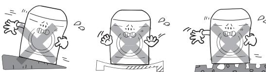
② Скорректируйте горизонтальность машинки с помощью регулируемых ножек.
