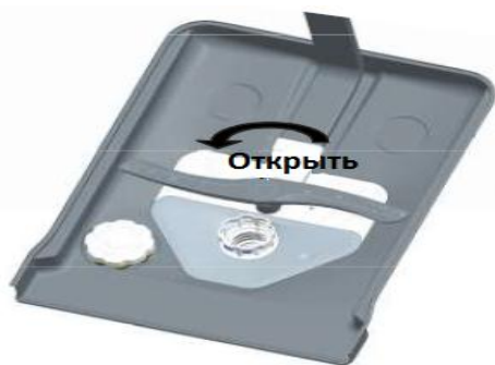
Шаг 1: Поверните фильтр против часовой стрелки.
