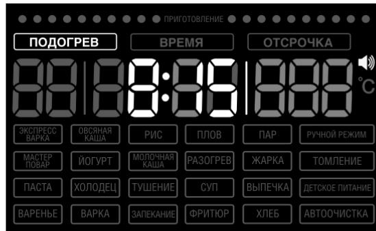
Когда программа приготовления будет завершена, прибор автоматически войдет в режим «ПОДОГРЕВ», и на дисплее будет отображаться время подогрева.
