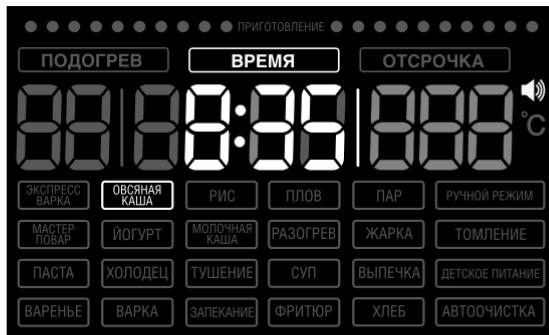
После выбора программы нажмите «Таймер/Температура» и кнопками «+» и «-» установите время приготовления блюда.
