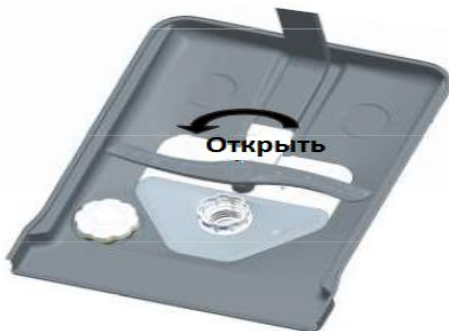
Шаг 1: Поверните фильтр против часовой стрелки.
