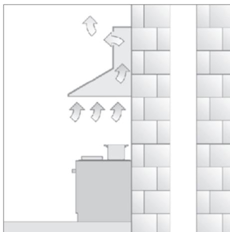
**Наибольшую производительность вытяжка обеспечивает в режиме отвода воздуха в вентиляционную шахту.**
