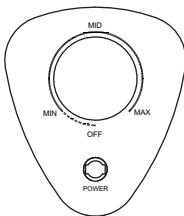
Выберите желаемый рабочий режим с помощью регулятора. На вашей модели может быть использован один из указанных вариантов.
