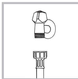
1. Прикрутите шланг подачи к крану холодной воды с резьбовым отверстием 3/4 газ (см. схему). Перед подсоединением откройте водопроводный кран до тех пор, пока из него не потечет чистая вода.
