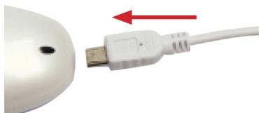
Подключите один конец USB-кабеля к мини-USB разъему прибора.
