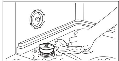
5. Чтобы закрыть емкость для соли, поверните крышку емкости для соли по часовой стрелке.
