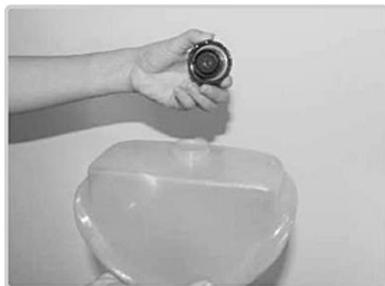
Убедитесь, что отпариватель отключен от электросети. Снимите бачок для воды и откройте крышку, поворачивая ее против часовой стрелки.
