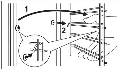
Установка направляющих производится в обратном порядке.
