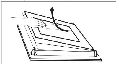
9. Вымойте стеклянную панель водой с мылом. Осторожно вытряните стеклянную панель досуха.
