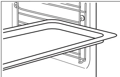
Одновременная установка решетки и глубокого противня:
