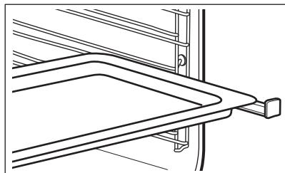
Одновременная установка решетки и противня для жарки:
