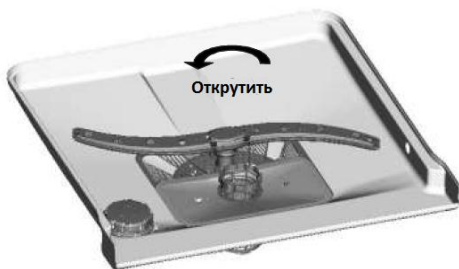
Шаг 1: Поверните фильтр против часовой стрелки.
