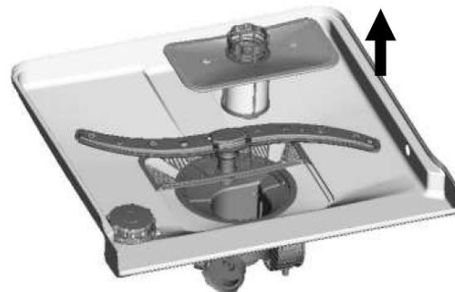
Шаг 2: Выньте фильтр движением вверх
