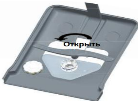
Шаг 1: Поверните фильтр против часовой стрелки.
