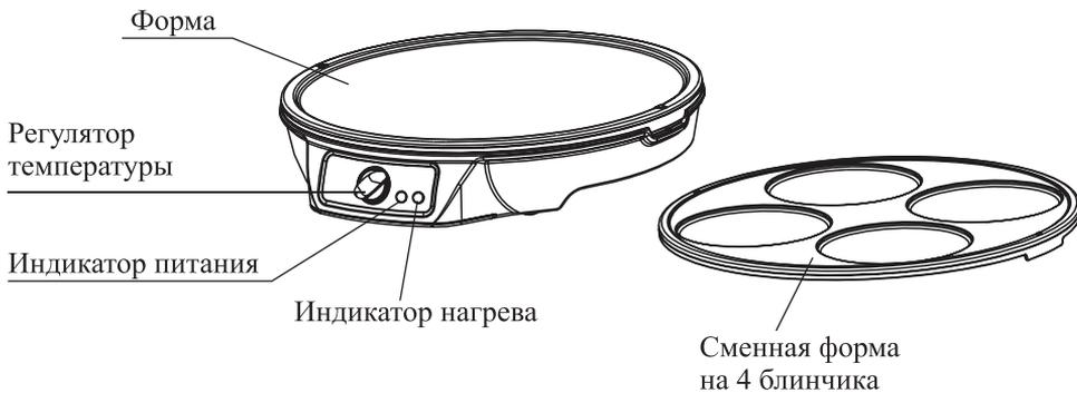
Индикатор питания загорается при включении блинницы. Индикатор нагрева горит в то время, когда блинница нагревается. Когда рабочие поверхности достигнут заданной температуры, нагрев выключится, и индикатор нагрева погаснет. Затем нагрев будет периодически включаться для поддержания температуры, в это время индикатор нагрева будет гореть. Таким образом, в процессе приготовления индикатор нагрева периодически загорается и гаснет.
