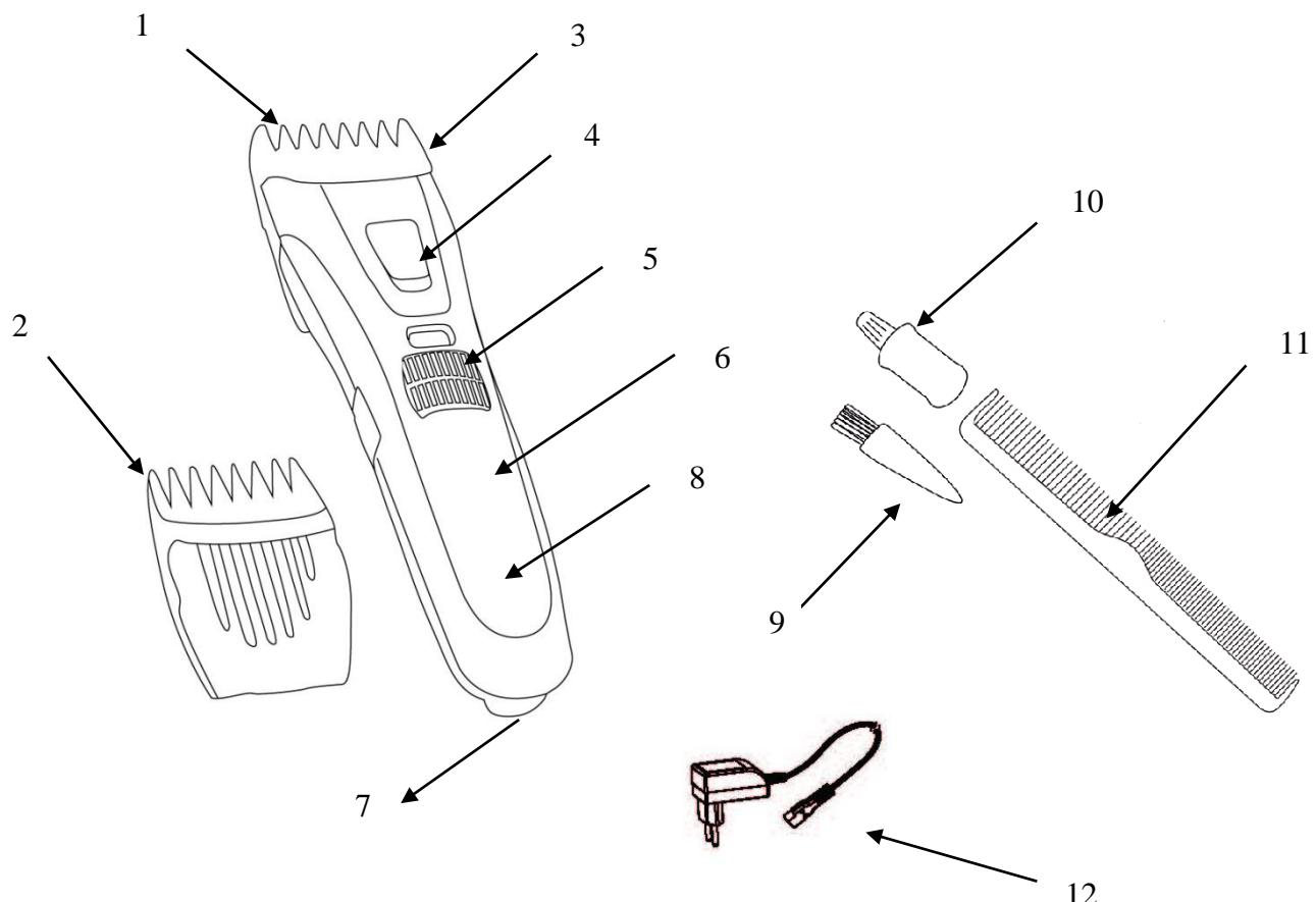
1. Съемная телескопическая насадка "А" 1-10мм
