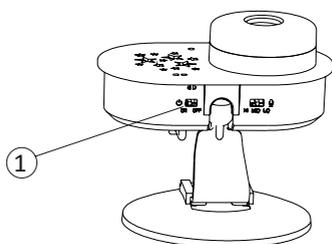
Полимерный аккумулятор (600mAh Li) уже установлен в камере. Достаточно только перевести переключатель (1) в положение ON.
