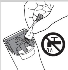
**6** Внутренние части прибора следует очищать с помощью щеточки.
