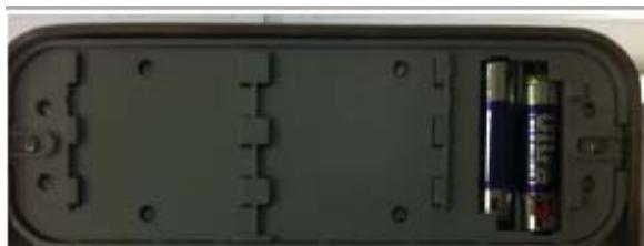
Установите 2 батарейки типа ААА, положение указано в батарейном отсеке.
