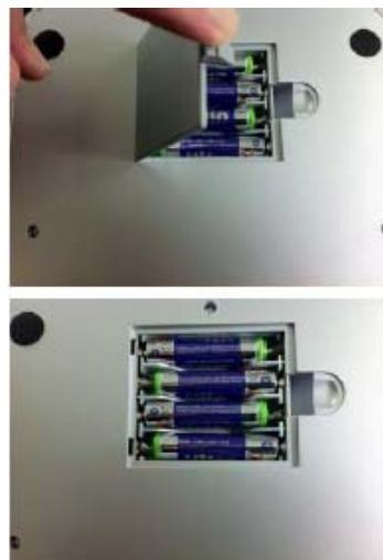
Вставьте 4 батарейки типа ААА, положение показано в батарейном отсеке.
