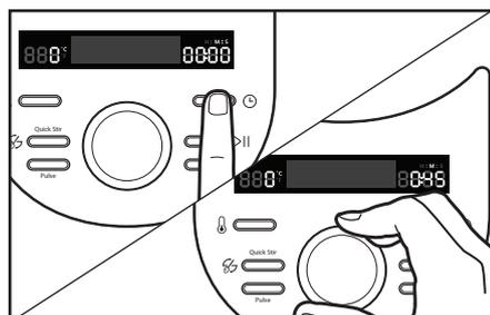
**2** Нажмите кнопку (Время) и выберите желаемое время готовки при помощи ручки регулировки
