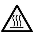
Это указание и индикация „Н“ на дисплее служат для предостережения, что керамическая панель может быть горячей. Хотя сама индукционная плита во время процесса варки не выделяет тепло, температура кухонной посуды нагревает конфорку!
