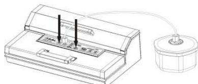
Нажмите на кнопку «Вакуумный контейнер». В начале процесса вакуумизации сильно прижмите крышку, чтобы предотвратить утечку воздуха.
