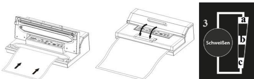
Убедитесь, что оба конца отверстия пакета расположены в вакуумной камере. Так будет достигнута наибольшая концентрация вакуума.
