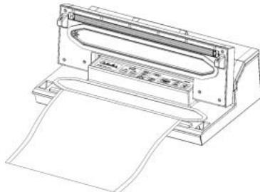
Расположите один конец пакета на сваривающей пластине, но не в вакуумной камере.
