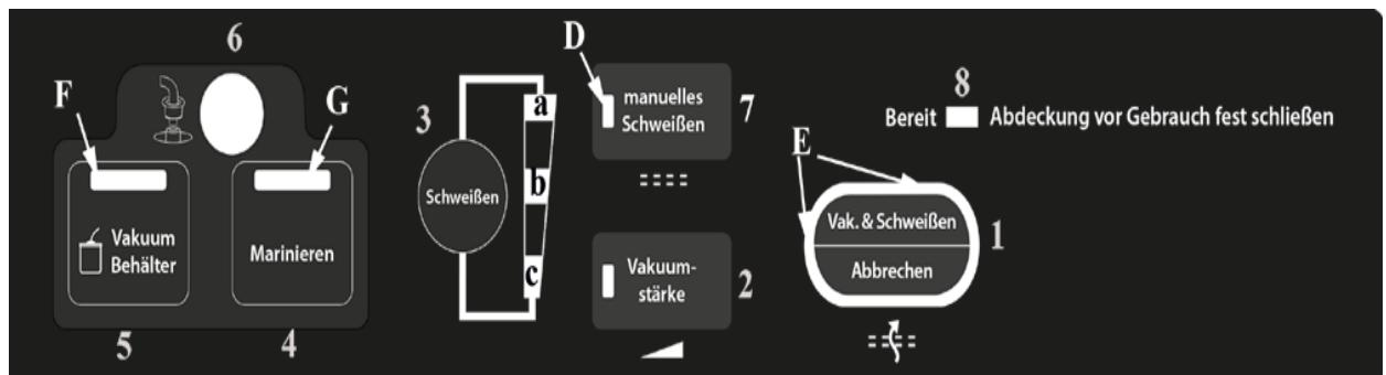
**1. Вакуум и сварка/отмена:** Эта кнопка имеет две функции в зависимости от того, какой режим используется:
