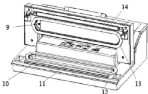
**9. Воздухосборник:** система подвода воздуха соединена с вакуумной камерой и насосом. Не накрывайте систему подачи воздуха при вакуумной упаковке продуктов и вакуумной запайке пакетов.
