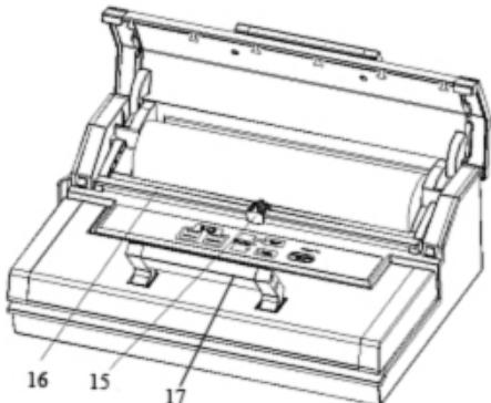
**15. Нож:** опустить вниз и повернуть с одной стороны в другую, чтобы разрезать пакет.
