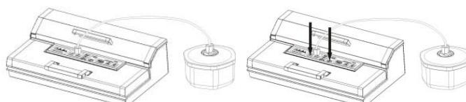
Закрепите один конец вакуумного шланга на входном отверстии прибора, другой конец закрепите на входном отверстии на крышке контейнера.
