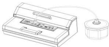
Закрепите один конец вакуумного шланга на входном отверстии прибора, другой конец закрепите на входном отверстии на крышке контейнера.
