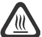
**Осторожно! Прибор нагревается. Опасность ожога!** Устанавливайте прибор на ровной, термостойкой поверхности на расстоянии не менее 70 см от воспламеняющихся материалов (например, штор).
