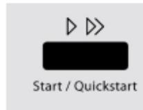
Чтобы настроить время приготовления 30 секунд, нажмите кнопку **Start/ Quickstart** (Пуск/Быстрый пуск) один раз, 1 минута - 2 два раза. Через 2 секунды печь начнет работу автоматически. По окончании времени приготовления микроволновая печь издаст четыре звуковых сигнала, на дисплее появится надпись **END** (КОНЕЦ).
