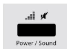
Чтобы включить или выключить звук (звуковой сигнал), в течение трех секунд нажмайте кнопку **Power/Sound** (Мощность/Звук). Сообщения о завершении программ и предупредительные сигналы будут раздаваться и при выключенном звуке.
