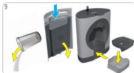
9 Опорожните сосуд. Наполните емкость для воды свежей питьевой водой. Установите емкость в машину. Поместите решетку поддона на поддон. Затем поместите поддон в нужное положение.
