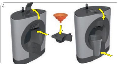
4 Поднимите блокирующую рукоятку. Вставьте промывочную воронку в держатель капсул. Вставьте держатель капсул в машину. Опустите блокирующую рукоятку. Поместите большой пустой сосуд под отверстие для выпуска кофе.
