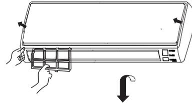
1. Для чистки фильтра используйте пылесос или промойте фильтр под водой, после чего просушите его.
