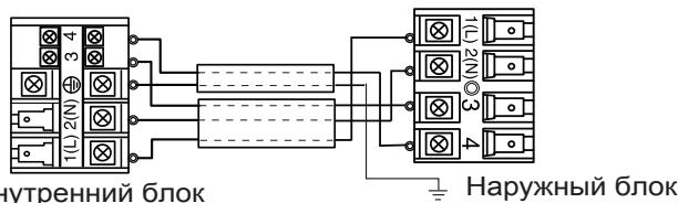
Сетевой кабель  $\geq 3G1,0\text{mm}^2$
