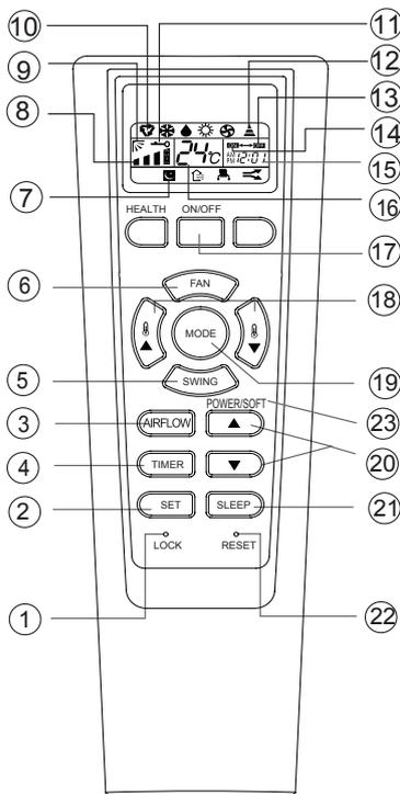
1. Кнопка LOCK используется для блокировки кнопок пульта дистанционного управления.
