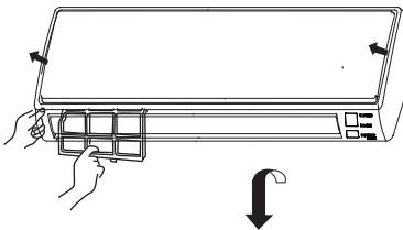
3. Для чистки фильтра используйте пылесос или промойте фильтр под водой, после чего просушите его.
