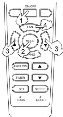
1. Для включения кондиционера нажмите кнопку ON/OFF, кондиционер включится в работу согласно последнему выбранному режиму.
