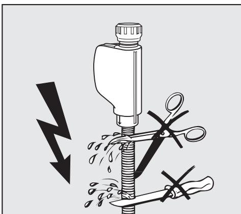
⚠ Не допускается укорачивание или повреждение шланга подачи воды, так как в нем имеются детали, находящиеся под напряжением (см. рис.).
