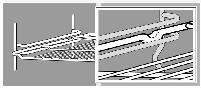
В зависимости от комплектации духовой шкаф может быть оборудован направляющими, фиксирующимися при полном выдвиге. Благодаря этому вы легко сможете установить противни и решетки. Чтобы разблокировать направляющие, задвиньте их в духовой шкаф с небольшим усилием.
