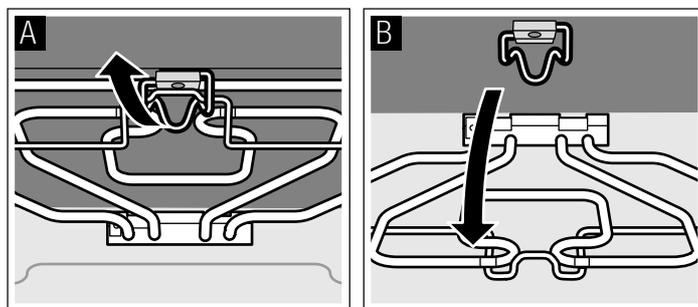
После окончания очистки снова закрепите нагревательный элемент гриля вверх. Сместите зажим гриля вниз и вставьте нагревательный элемент на место.
