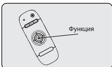
1. Используйте пульт ДУ для зарядки. На пульте ДУ нажмите функциональную кнопку. Пылесос будет искать док-станцию автоматически.
