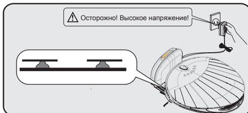
2. Используйте док-станцию для зарядки. Подключите адаптер к док-станции. Установите пылесос на док-станции, совместив электроды док-станции и пылесоса. Подключите адаптер к сети питания.
