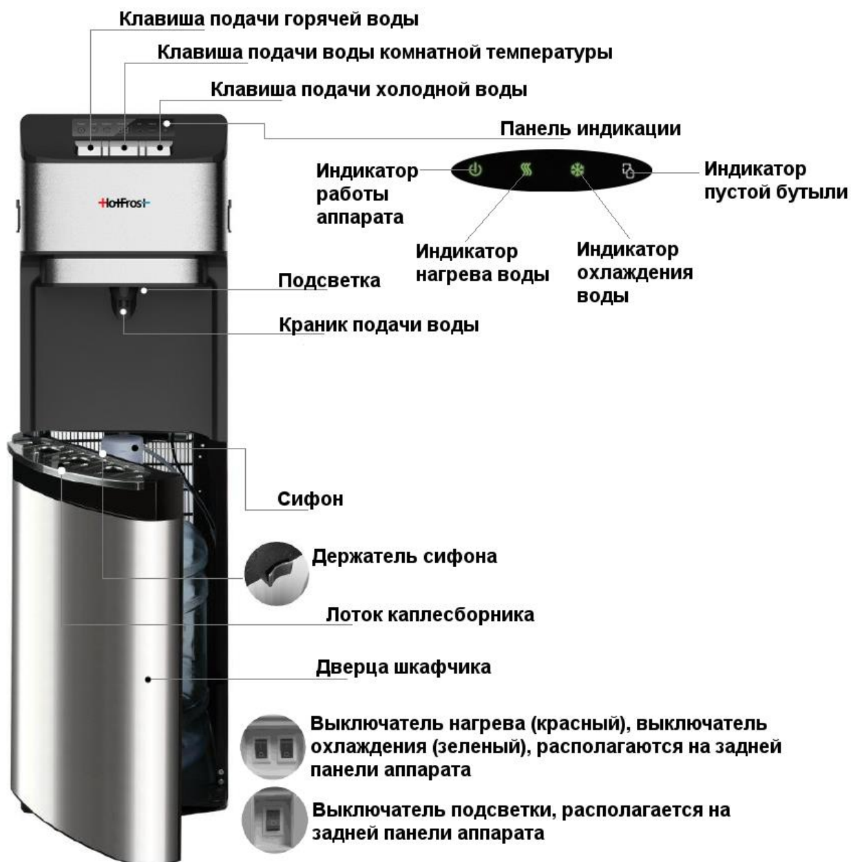
Рис.1 (с) Схема аппарата 40А (S,N)
