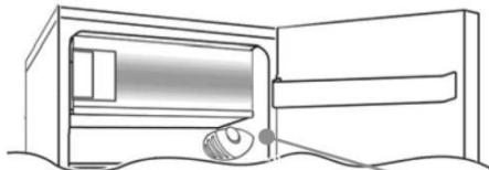
Панель термостата для управления прибором находится внутри холодильной камеры в правом верхнем углу. Если прибор не функционирует должным образом, убедитесь, что регулятор термостата не установлен на "0".
