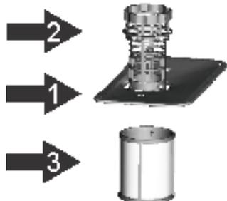
Система фильтрации состоит из фильтра грубой очистки, основного фильтра и микрофильтра (фильтра тонкой очистки).
