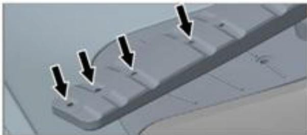
Чтобы облегчить очистку, можно снять разбрызгиватели. Не забудьте надежно установить их обратно после очистки.
