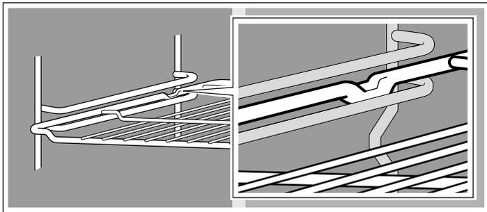
В зависимости от комплектации духовой шкаф может быть оборудован направляющими, фиксирующимися при полном выдвигении. Благодаря этому вы легко сможете установить противни и решетки. Чтобы разблокировать направляющие, задвиньте их в духовой шкаф с небольшим усилием.
