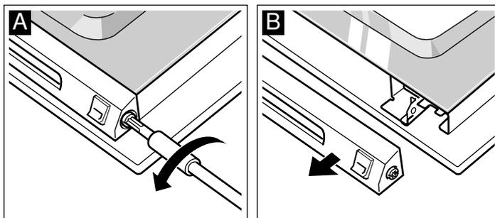
Проследите за тем, чтобы дверца духового шкафа не закрылась, пока панель будет снята. Внутреннее стекло может быть повреждено.
