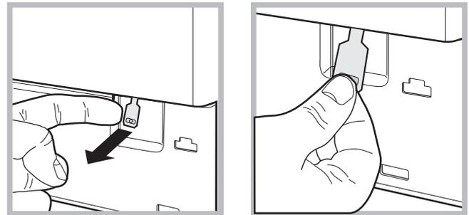
4. потяните наружу язычок, показанный на схеме, вплоть до освобождения пластикового блокировочного винта. Затем потяните его вниз и одновременно откройте люк.
