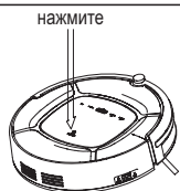
A. Нажмите на центральной крышке отметку «пылесборник», чтобы открыть центральную крышку
