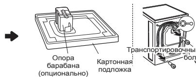
Снимите транспортировочные болты и опоры.
