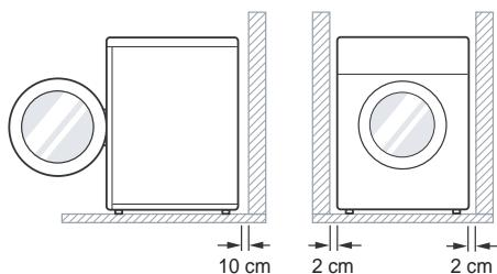
**Ровный пол** : допустимый уклон пола под всей занимаемой машиной площадью не должен превышать 1°.
