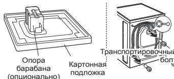
Снимите транспортируочные болты и опоры.
